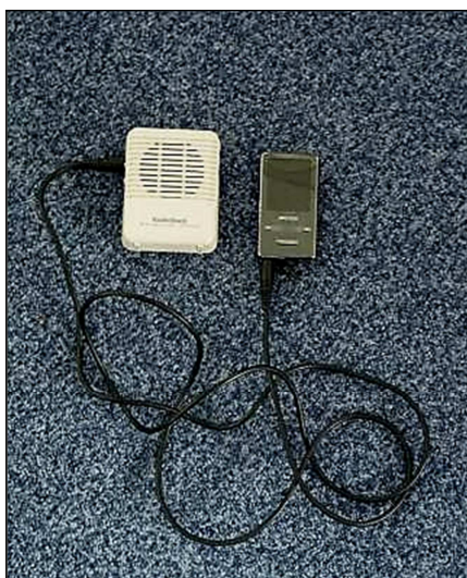
Matériel de « repasse » : lecteur MP3 raccordé à une enceinte portable par un câble Jack – Ecosphère
